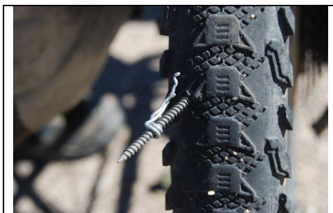
80. Саморез зашел шляпкой (это не самодельная шипованная резина для перевала!)
