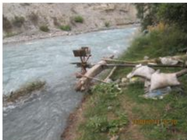
От этих лопастей вращается генератор
