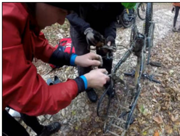
Замена свернутого петуха
