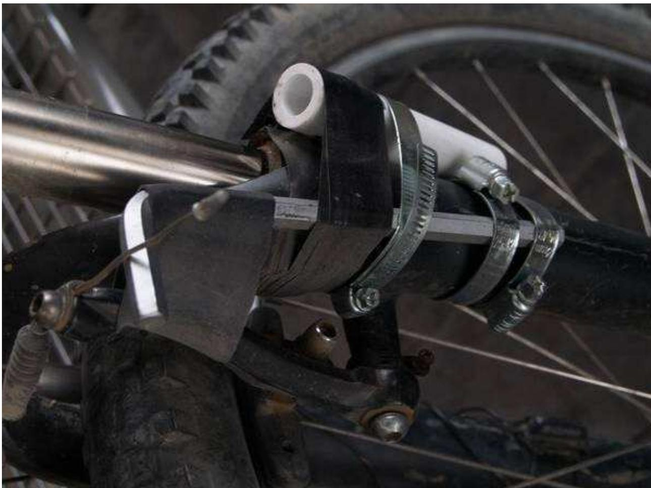
Отремонтированный передний тормоз (вместо сломавшейся пружины рычаг возвращается резинкой)
