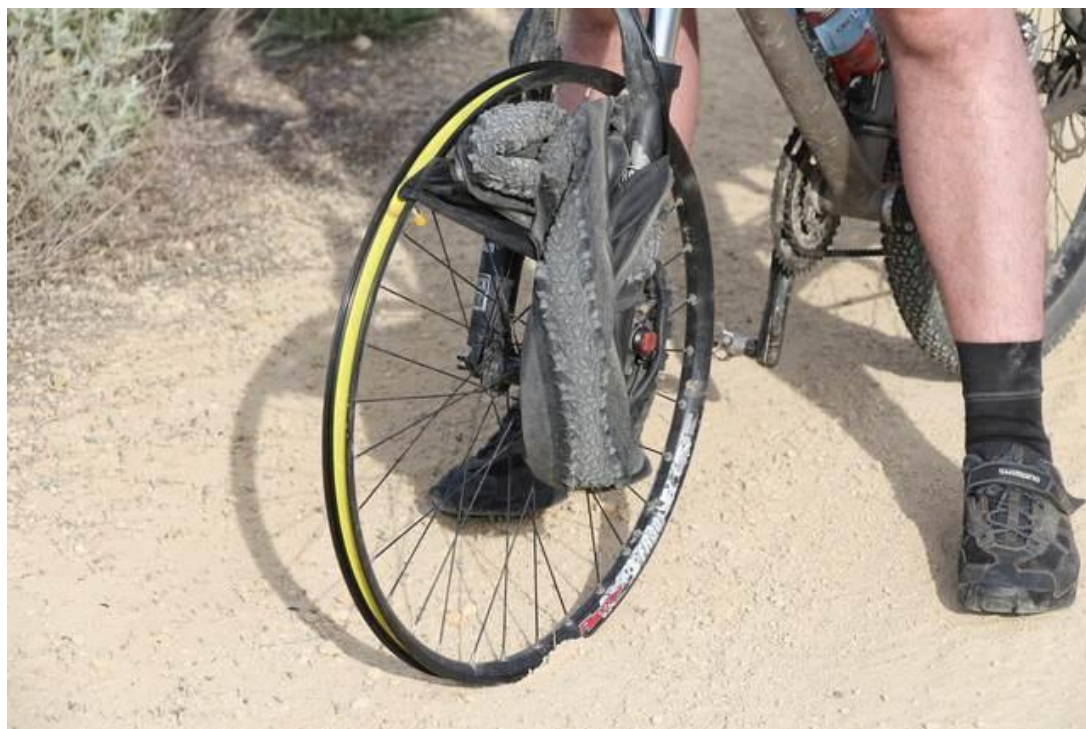
Рис.6 Сорванная с колеса покрышка
